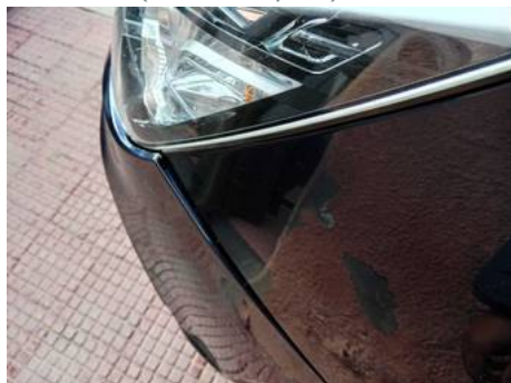
Bouclier avant (Défaut aspect)
